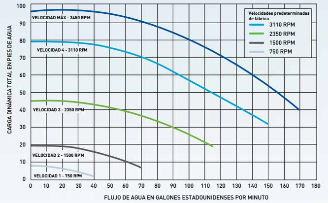
NOTA: La tabla de arriba muestra los índices de rendimiento a velocidades predeterminadas de fábrica de 750 RPM, 1500 RPM, 2350 RPM y 3110 RPM.
